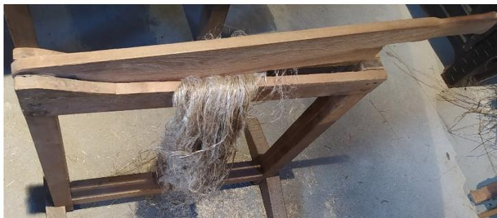
Appareil à teillage du lin : il faut l'actionner pour débarrasser les fibres de l'écorce, et obtenir une tige la plus souple possible. Ce n'est pas de tout repos...
